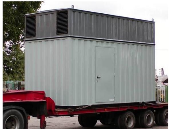
Akustická kapota diesel motoru Perkins s tlumeným sáním, výdechem a odděleným tlumičem výfuku.
