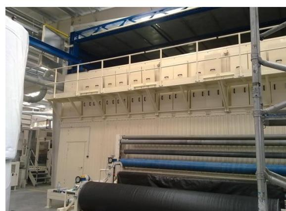
Při lineárním pohybu šicích hlav vzniká tlaková vlna, která ničí vnější opláštění vlastní výrobní haly. Z těchto důvodů jsou na šicích strojích instalovány akustické kryty, které zároveň zajišťují limitní hodnoty hluku na pracovištích.
