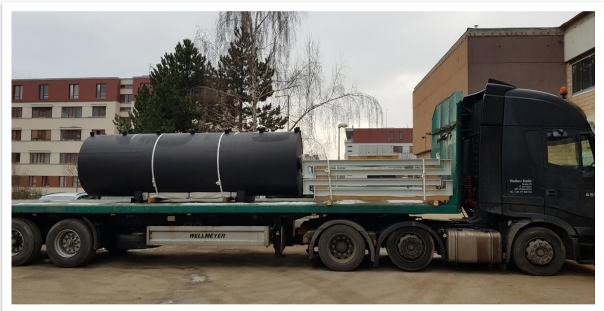
Obr. 6B – Tlumiče hluku včetně ocelové konstrukce (efektivní využití dopravy):
